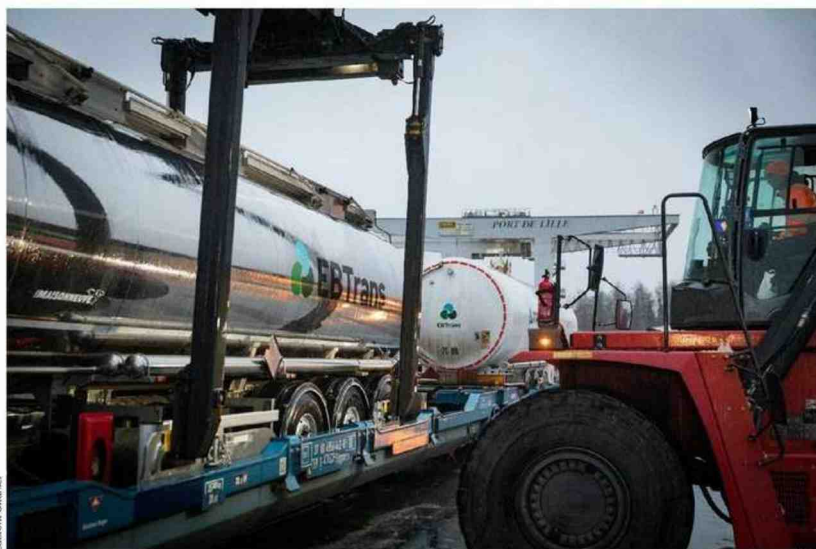
Sur le train Be Modal parti de Rennes le 7 février 2024, un wagon-poche VTG de type T3000 a accueilli deux semi-remorques citernes non préhensibles EB Trans grâce à une corbeille « connecteur » r2L (Road-rail-Link). Photo du déchargement d'une semi-remorque par une reach stacker sur la plateforme Lille Conteneurs Terminal, le 8 février. Cette démonstration devrait laisser place à une offre régulière au cours des prochains mois.
